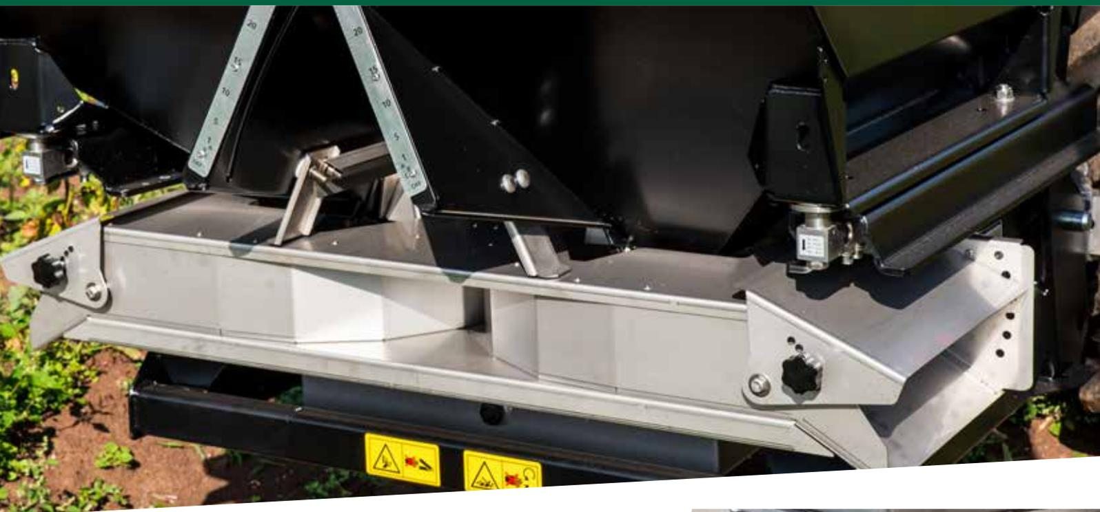
TOUS les composants en contact direct avec l'engrais (fond de la trémie, grilles de protection, vannes d'ouverture et de fermeture, disques d'épandage, pales d'épandage, carters de protection, boulonnerie et agitateurs) sont en ACIER INOX.
