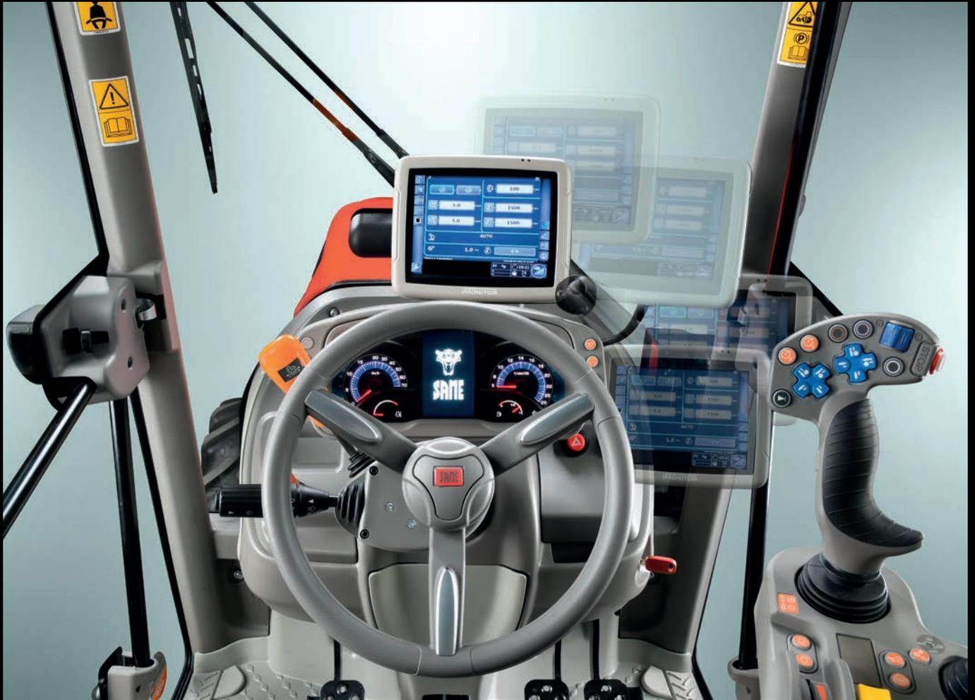
Une solution unique, intégrée au siège conducteur, avec toutes les fonctions à portée de main et qui, grâce au réglage de la longueur, permet de travailler toujours assis avec le coude reposant sur un confortable accoudoir.
